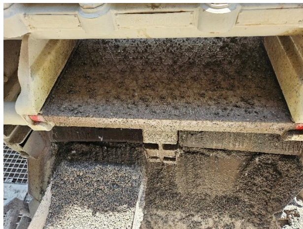
Figure 4-36 : Passage des boues sur tamis vibrants
