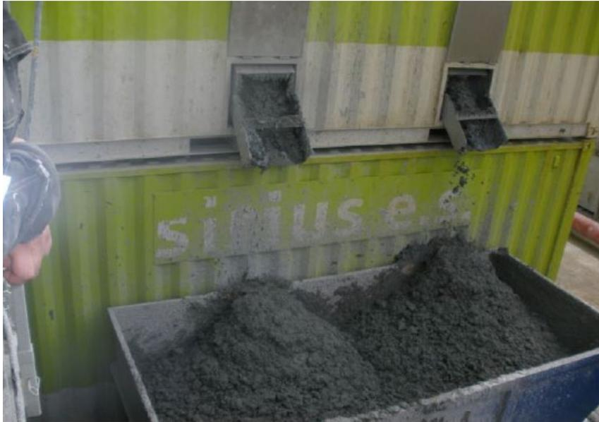
Figure 36 : Fraction fine à la sortie des centrifugeuses avant mise en décharge.
