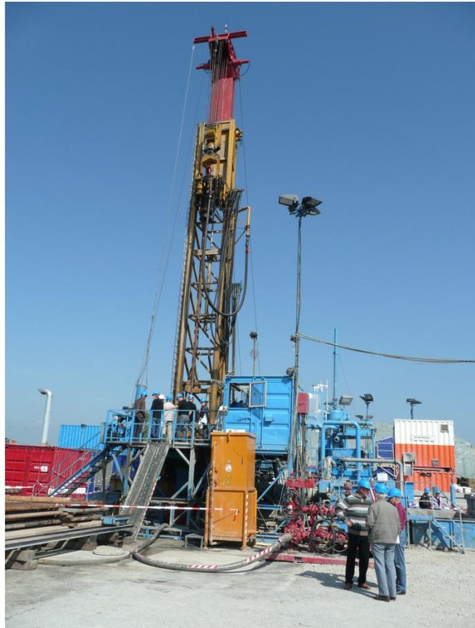
Figure 25 : Exemple d'une installation de forage susceptible de réaliser un forage d'exploration : Foreuse Wirth B12 (charge maximale 152 T) à Schlattingen (TG), avril 2011. Exploration géothermique, profondeur atteinte 1508 m
