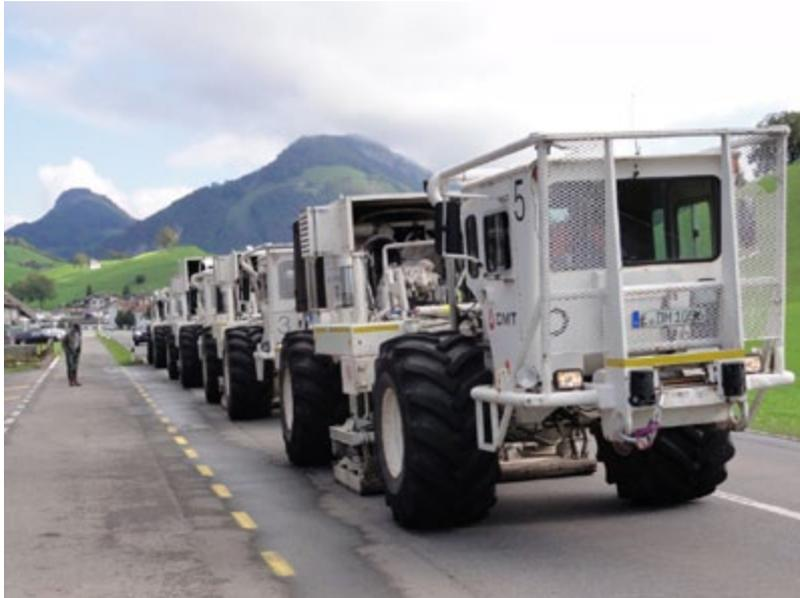
Figure 24 : camions vibreurs lors d'une campagne de sismique-réflexion.
