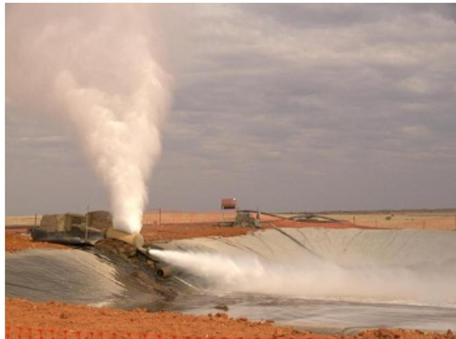
*Figure 41 : premier test de circulation des forages géothermiques de Habanero en Australie (source : Geodynamics Limited)*
